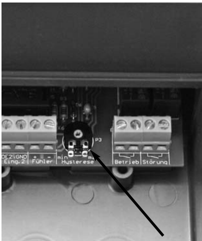
Fig. 4: Réglage de la différence de commutation
